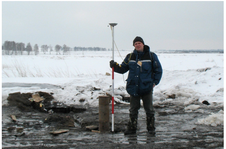
Д.Б. Новоселов ведет съемку в режиме «кинематика»
